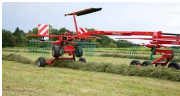
Prześwit 50cm pod karuzelami, zapewnia swobodne pokonywanie poprzecznych pokosów.
