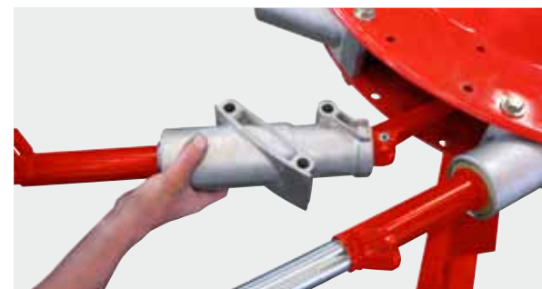
Każde ramię przekładni ProLine można indywidualnie odkręcić.
