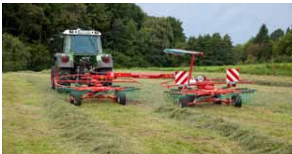
Obydwie zgrabiarki mogą składać dwa mniejsze pokosy w jednym przejeździe.
