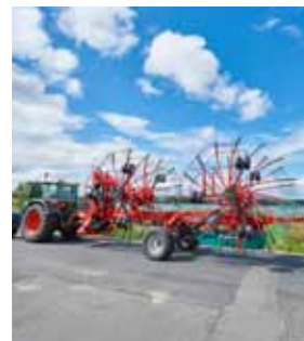
Transport z wysokością poniżej 4 m i to z założonymi ramionami.
