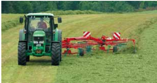
SideShift z karuzelą po lewej stronie – ciągnik porusza się po uprzednio zgrabionej części pola.
