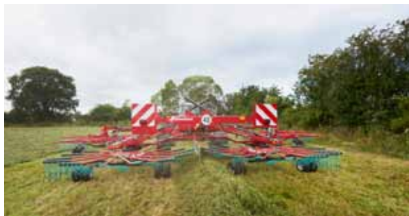
Hydrauliczna regulacja szerokości pokosu.
